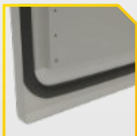
Para garantizar un correcto sellamiento de las puertas al cuerpo de los gabinetes y armarios, empleamos un sistema de inyección en poliuretano el cual se aplica directamente sobre la superficie de las puertas, garantizando la hermeticidad del producto en el cerramiento.
